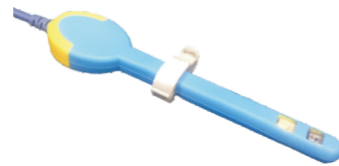
R系列 动物直肠血氧/脉搏/温度探头, 1M
